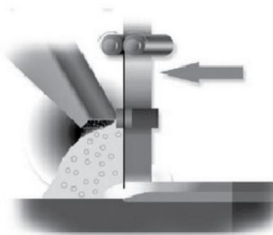
Fig. 2 Electroslag Welding
